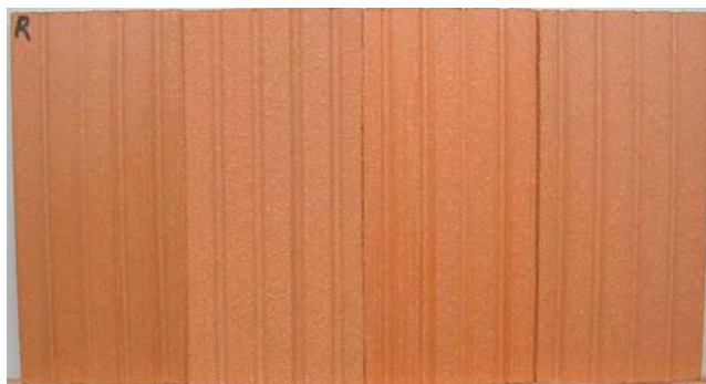
Foto 1. Van links naar rechts, referentie A, monster 1A, 4A en 5A na 100 uur snelverwering.
