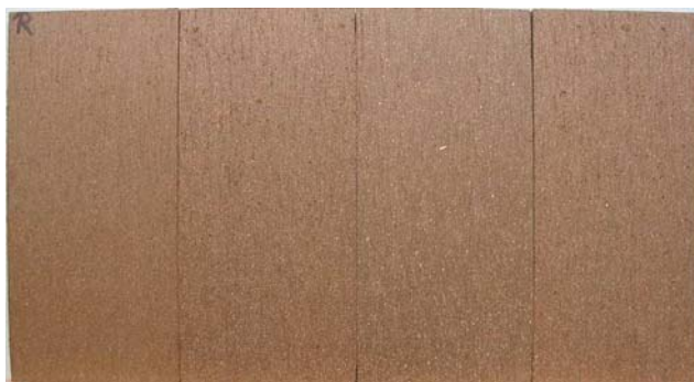
Foto 2. Van links naar rechts, referentie B, monster 3B, 4B en 5B na 100 uur snelverwering.
